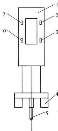
图 3.1.4 数字式贯入深度测量表示意
