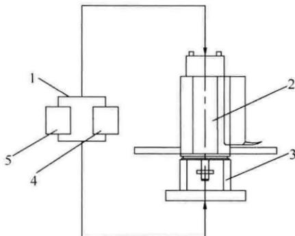
图 A.1.1 贯入力校准示意
