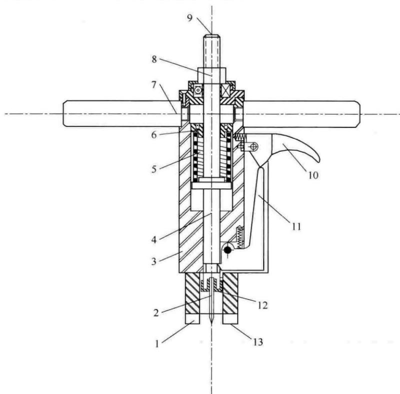
图 3.1.1 贯入仪构造示意
