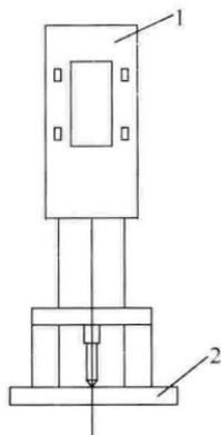
图 4.3.4 贯入深度测量表清零示意
